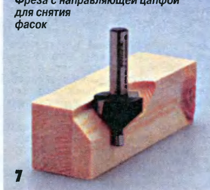
Фреза с направляющим подшипником для пригонки кромочного материала
