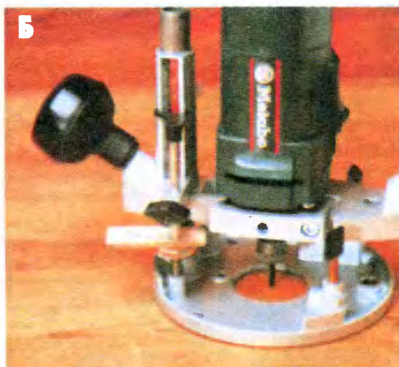
Б Прокладка позволяет быстро настроить машинку на необходимую глубину фрезерования.
