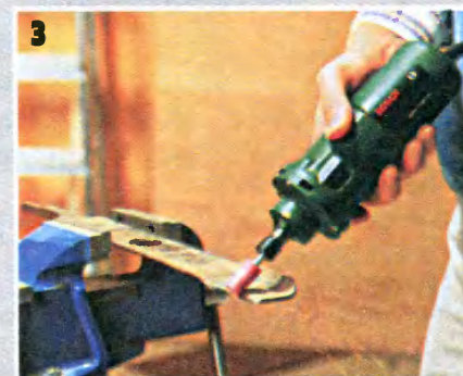
Высокооборотный привод машинки используют и автономно для шлифования и полирования поверхности (фото 3).
