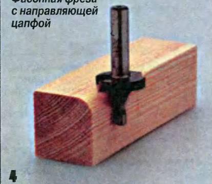
Фреза с направляющим подшипником для пригонки кромочного материала
